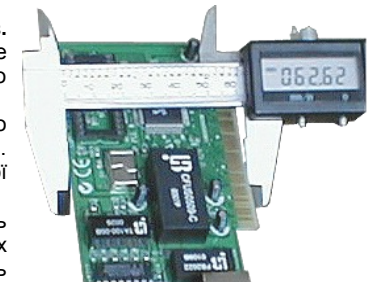
Фото 5. Вимірювання висоти плати розширення
