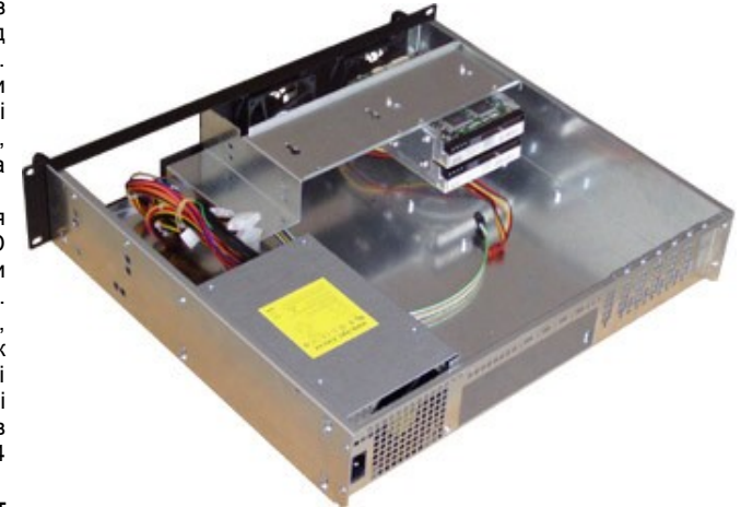
Фото 4. Корпус з установленою корзиною HDD
