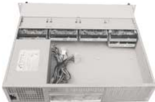
Фото 3. HDD, установленные в корпусе.
