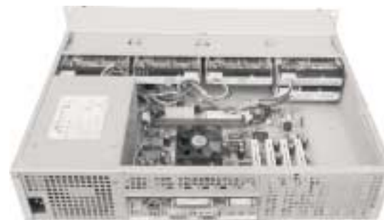
Фото 4. Корпус с установленными вентиляторами, материнской платой, HDD.
