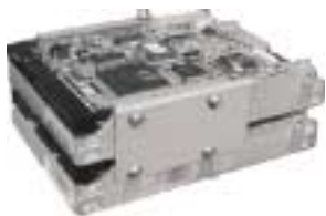
Фото 2. Блок из двух HDD.
