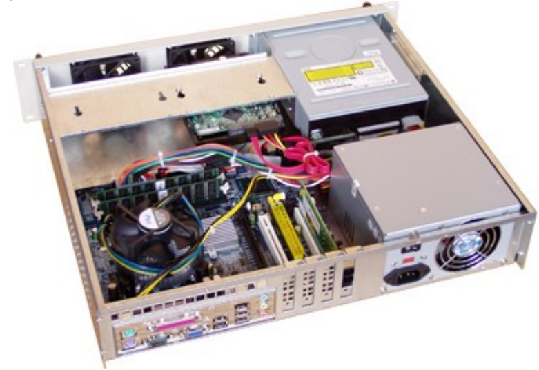
Фото 4. Корпус з установленими компонентами
