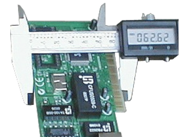
Фото 5. Вимірювання висоти плати розширення
