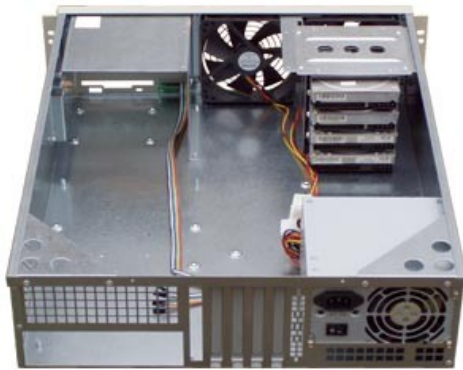
Фото 1. Чотири HDD в корпусі D34
