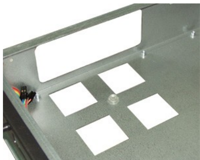
Фото 2. Установка опорної ніжки на лотку під материнку в місці установки процесорного кулера
