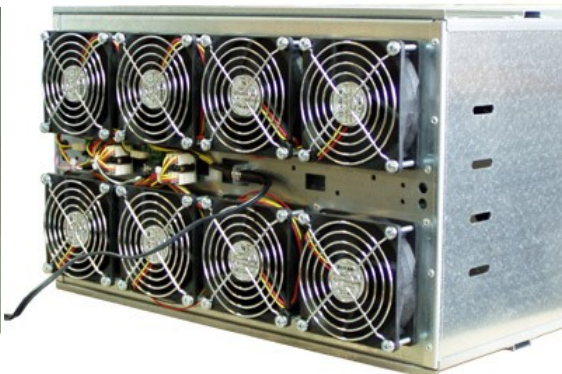
Фото 3. Задня частина корпусу з установленими вентиляторами та платами FanMagic
