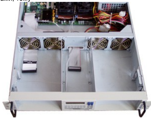
Фото 2. Прокладання шлейфів в корпусі
