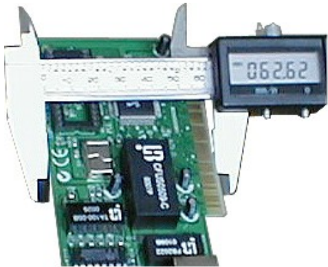
Фото 1. Вимірювання висоти плати розширення
