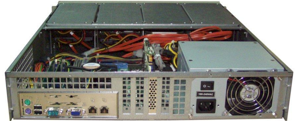
Фото 2. Комп'ютер, зібраний в корпусі DL26
