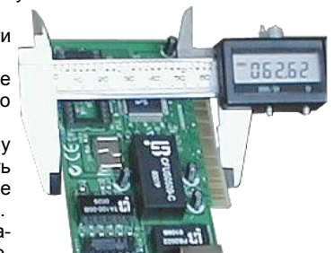
Фото 3. Вимірювання висоти плати розширення
