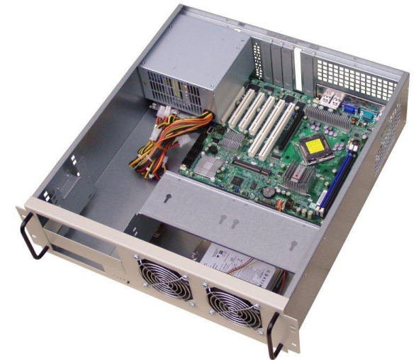
Фото 3. Материнська плата АТХ в корпусі DL32, блок живлення навісає над краєм плати.
