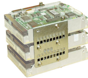
Фото 2. Корзина ZHD32 з закріпленими HDD, купується окремо від корпусу
