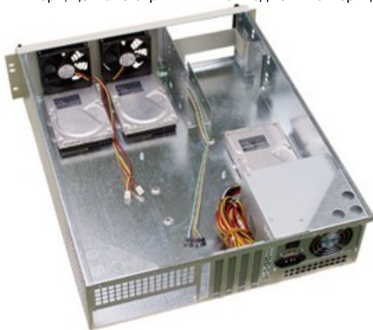
Фото 1. Установка трьох HDD в корпусі DL32
