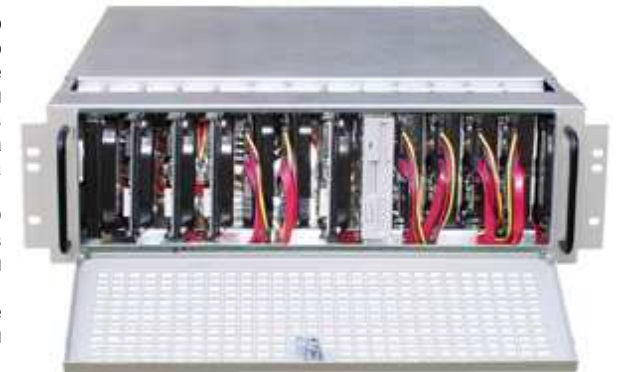
Фото 2. Розміщення HDD в корпусі DL36
