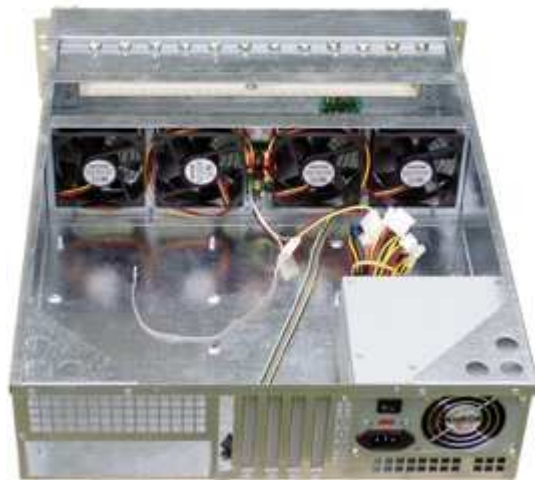
Фото 1. DL36 з установленими вентиляторами і платою FanMagic
