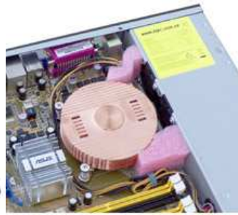
Фото 3. Установка прокладок радіатора процесора
