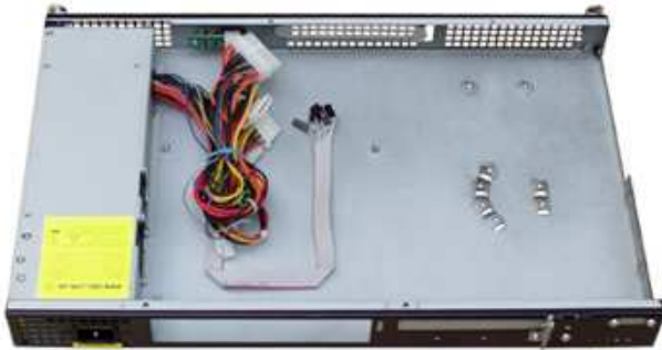
Фото 2. Корпус, підготовлений до установки материнської плати
