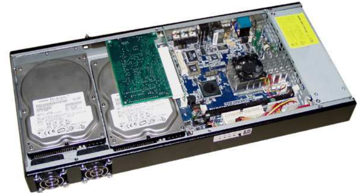
Фото 2. Корпус з материнкою, двома HDD та платою розширення на райзері 1R
