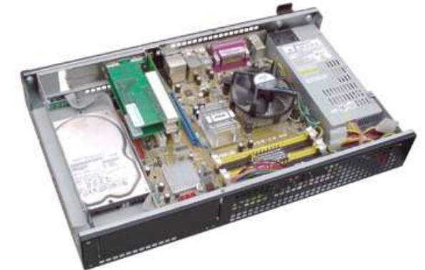
Фото 3. Корпус з материнкою micro-ATX, процесорним кулером висотою 45мм, одним HDD та двома платами розширення на райзері 1U5Rx2
