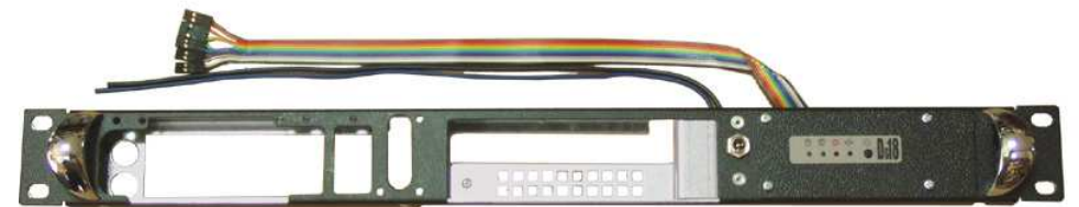
Фото 3. Передня панель, підготовлена для установки в корпус
