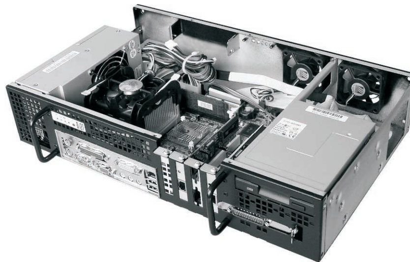
Фото 3. Корпус, подготовленный для крепления в 19" стойке тыльной стороной.
