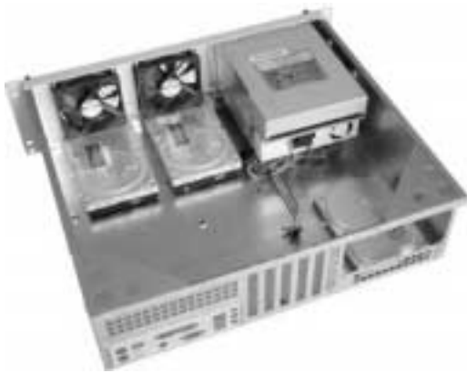
Фото 1. Крепление HDD в базовой версии корпуса спереди возле вентиляторов и под блоком питания.
