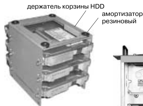
Фото 2. Корзина HDD с держателем и амортизаторами.
