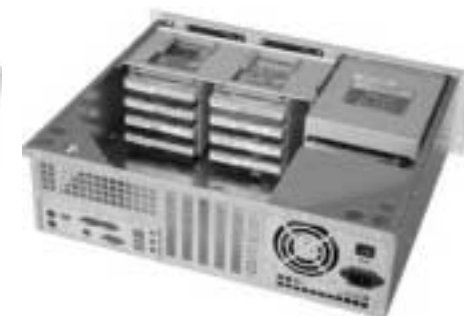
Фото 5. Крепление двух корзин HDD в корпусе DS32-H2.
