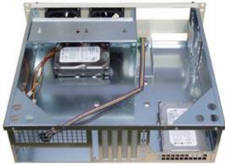
Фото 1. Два HDD кріпляться на дні.
