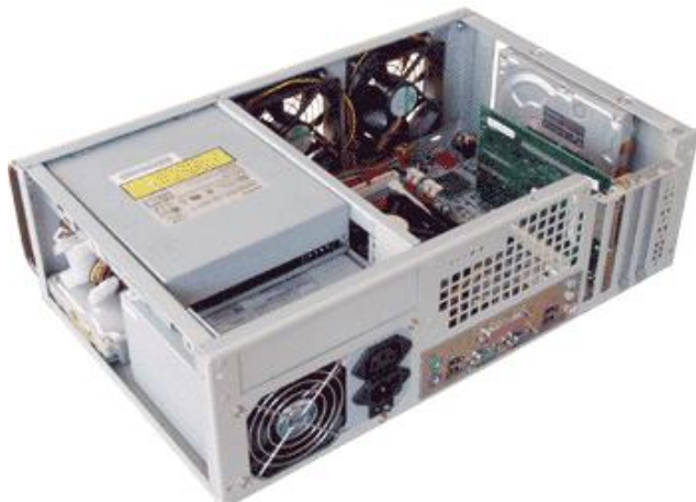
Фото 3. Корпус з установленими материнською платою, двома HDD, CD Drive, вигляд ззаду
