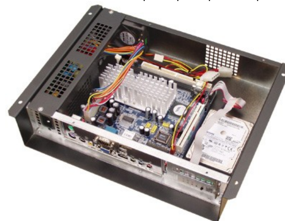
Фото 2. Система з материнкою, 2,5" HDD, двома картами розширення на райзерах
