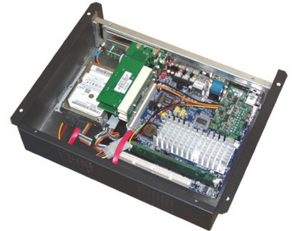
Фото 2. Система з материнкою, БЖ, 2,5" HDD, двома картами розширення на райзері.
