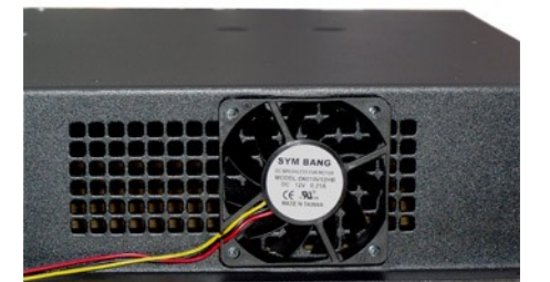
Фото 5. Установка додаткового вентилятора на боковій панелі ззовні корпусу.
