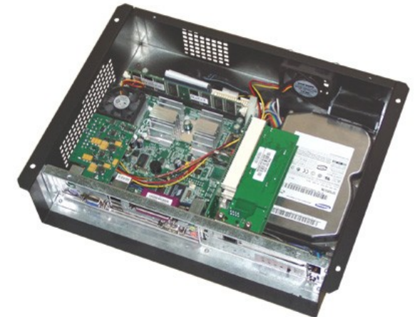
Фото 2. Система з материнкою, БЖ, 2,5" HDD, двома картами розширення на райзері.
